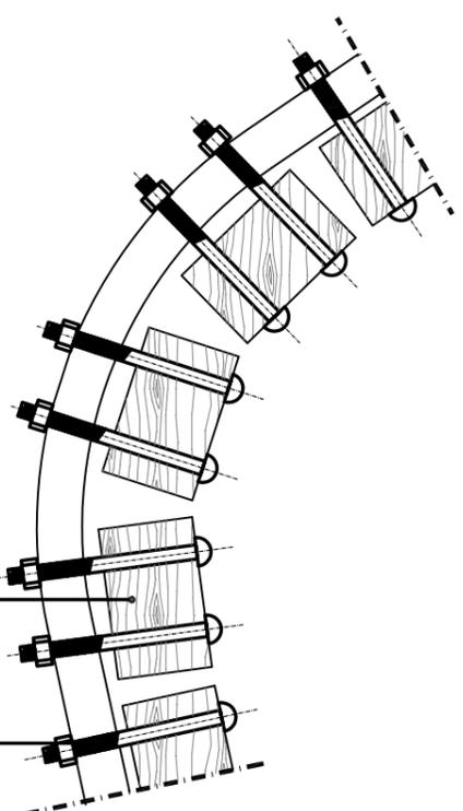
PARTICOLARE COSTRUTTIVO DEL FISSAGGIO DEI LISTELLI DI LEGNO ALLA STRUTTURA IN ACCIAIO
